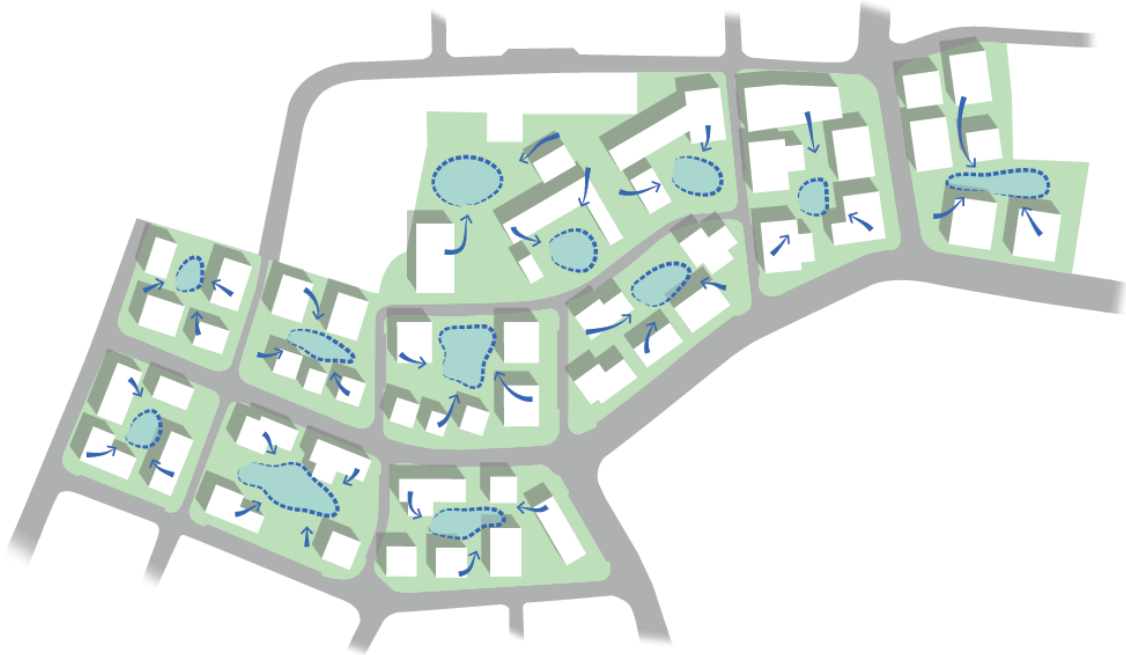
איור 4 | שילוב שטח פתוח בכל מבנן - בדוגמא שילוב שטח פתוח (ציבורי או פרטי) נמוך מסביבתו בכל בלוק, מאפשר השהייה של מי הנגר במבנן, לפני הפניה שלהם למערכת העירונית. (תכנית מס' 415-0838573, מתחם יוספטל, רמלה)
