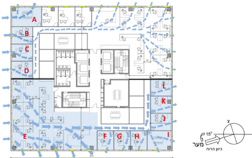
איור 1.30 בחינת אורור נוחות על גבי קומת משרדים טיפוסית המחולקת לשני דיירים. פתחי כניסת האוויר ויציאתו סומנו בצהוב.
